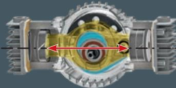
Beide Kolben werden linear auf derselben Achse geführt. Dies verhindert eine Verschränkung der Kolben in der Zylinderlaufbahn.
