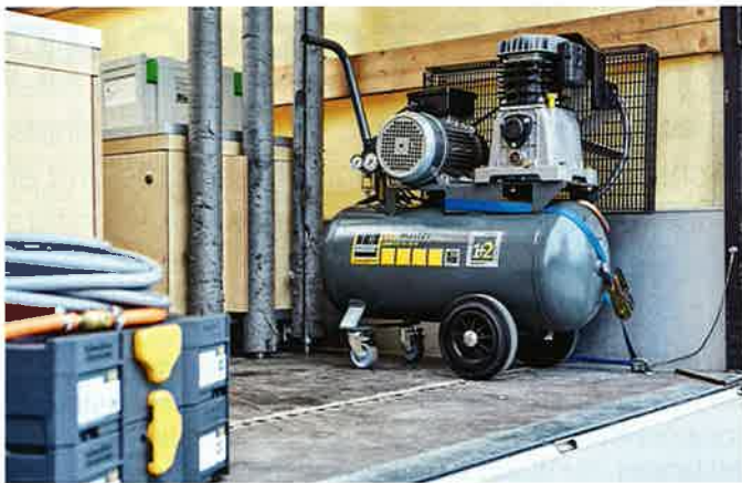
Mobil mit Lenkrollen und verlängertem Handgriff: der Unimaster
