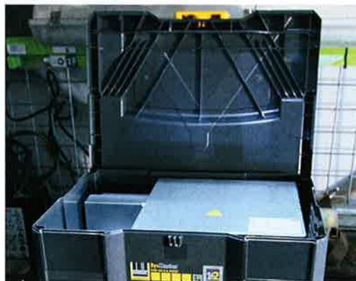
Druckaufbau: Fällt der Arbeitsdruck unter 4 bar, springt der Kompressor automatisch an – vorausgesetzt, das Gerät ist an eine 230-V-Dose angeschlossen. Zudem praktisch: Bei geöffnetem Systainer (rechtes Bild) lässt sich beispielsweise das Stromkabel verstauen. Bilder: Blenk
